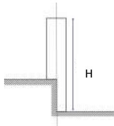
La clôture peut suivre la pente du terrain naturel. La hauteur est mesurée aux deux extrémités de la clôture.
