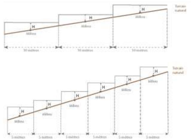
Dans le cas d'une clôture mitoyenne, la hauteur maximale autorisée est mesurée à partir du point le plus bas du terrain naturel.
