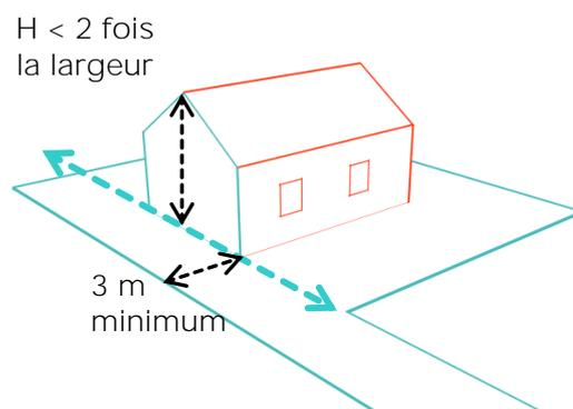
Fig. 5 - Implantation de constructions sur une même propriété
