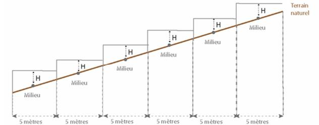
Dans le cas d'une clôture implantée sur la limite séparative, la hauteur maximale autorisée est mesurée à partir du point le plus bas du terrain naturel.
