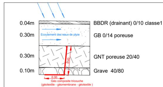
Principe de mise en place de batardeau sur chaussée réservoir pour diminuer les effets de pertes de volume liés aux pentes
