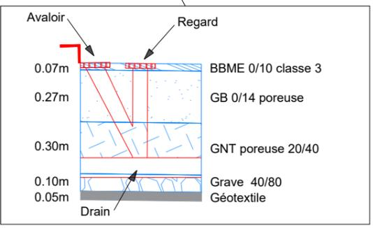
Chaussée réservoir à enrobé imperméable en carrefour
