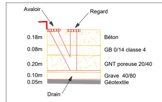
Place à structure réservoir
