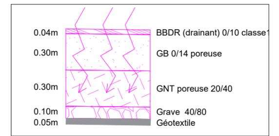
Chaussée réservoir à enrobé drainant en section courante
