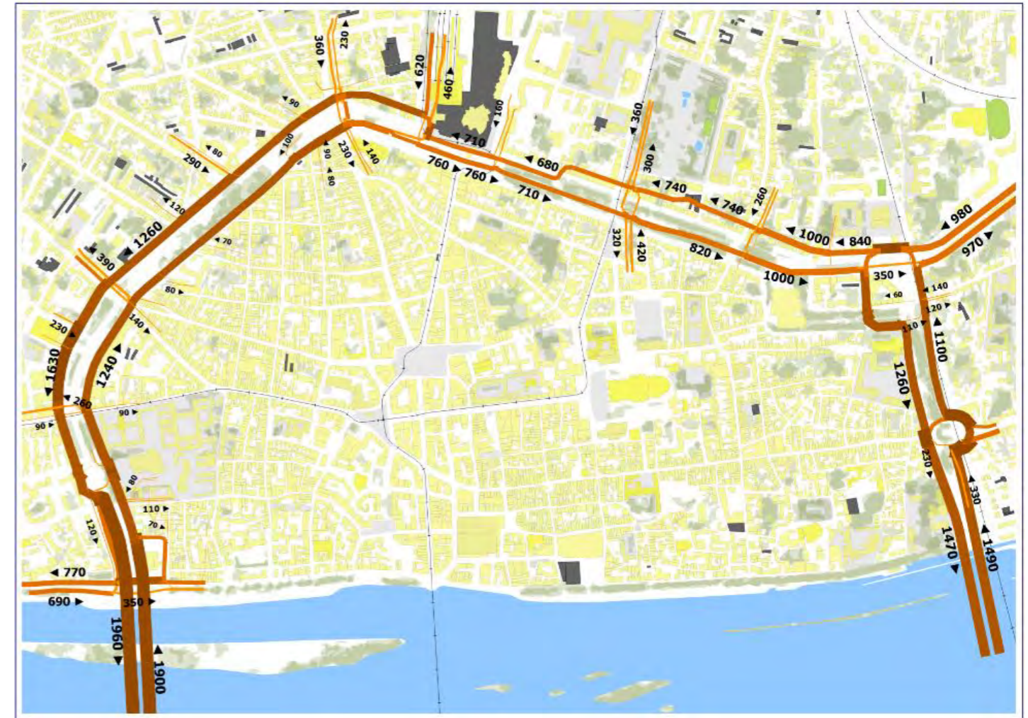
Figure 409 : Charge de trafic projeté en heure de pointe soir en u.v.p./h (Source : DYNALOGIC)
