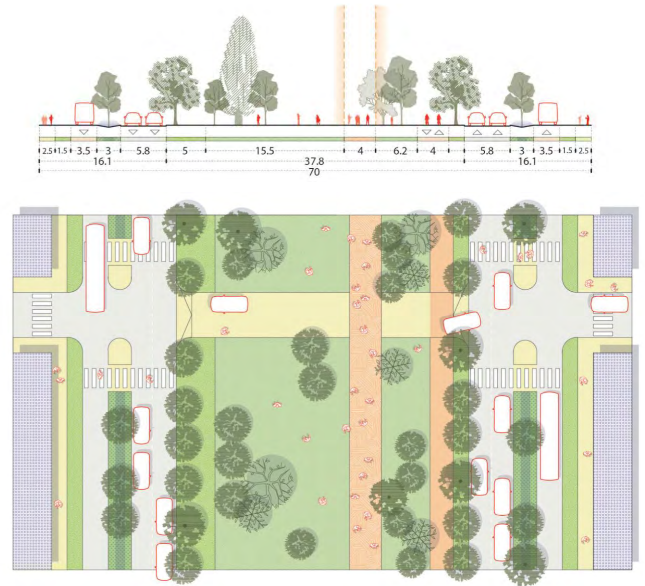
Figure 88 : Coupe et plan de principe de l'état projeté des Mails d'Orléans (Source : groupement MOE – étude AVP 2024)
