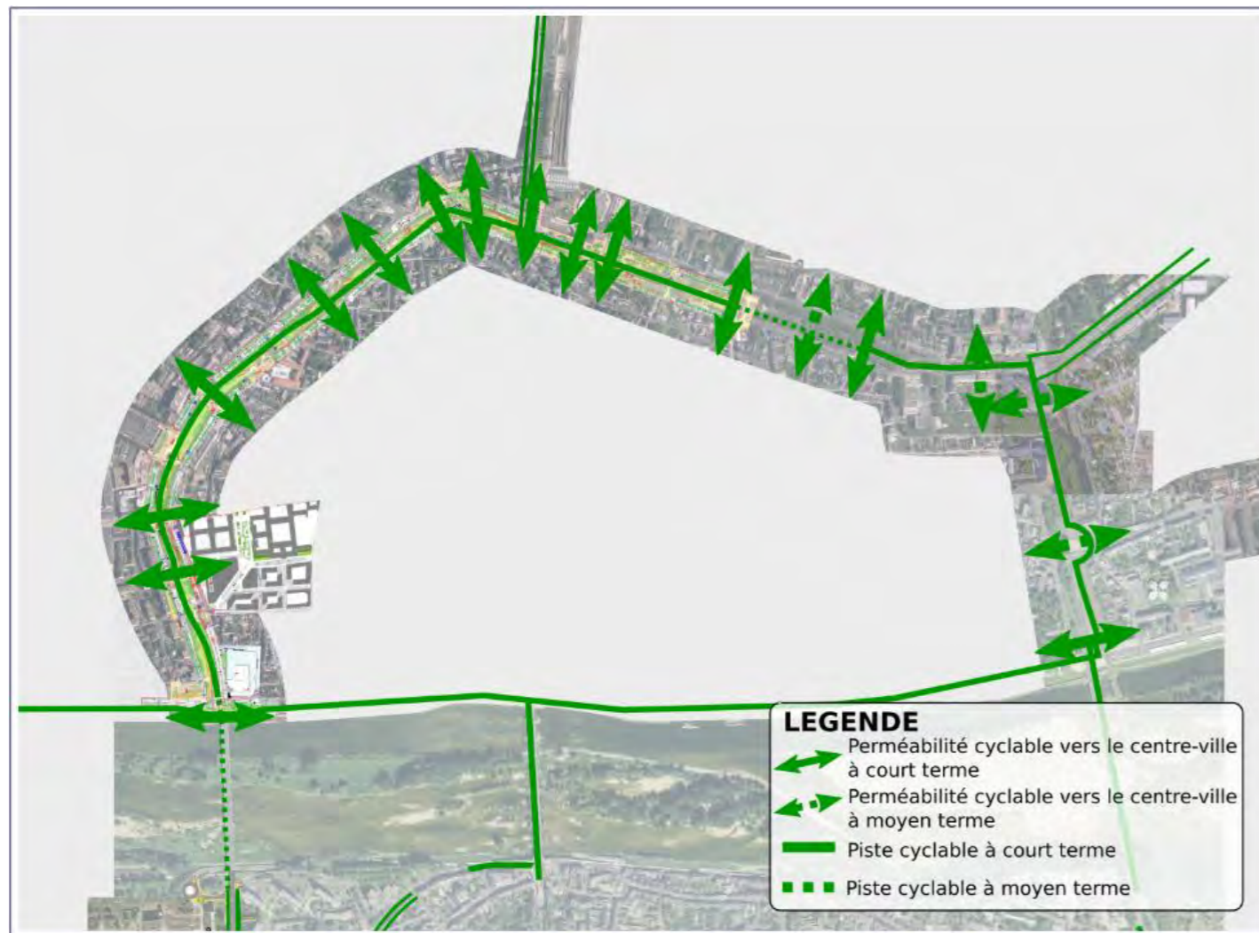
Figure 399 : Les aménagements vélo projetés (Source : DYNALOGIC)
