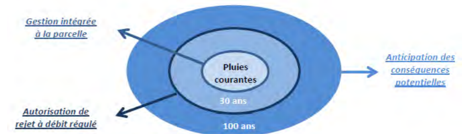
Figure 486 : Présentation des 3 niveaux de gestion des EP - Extrait du Zonage pluvial ORM
