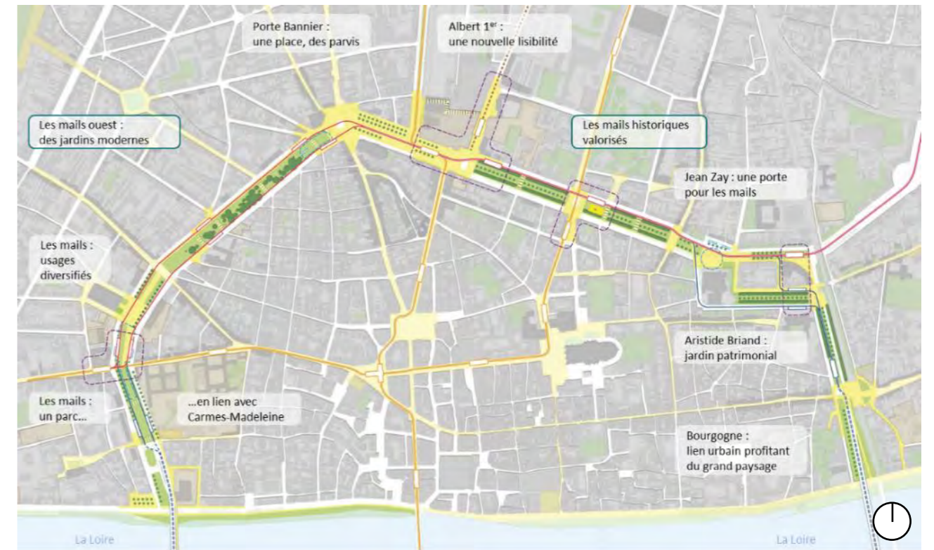
Figure 49 : Schéma du scénario avec un TCSP bilatéral sur la partie Ouest des Mails et unilatéral sur la partie Est (Source : groupement AMO – étude Plan Guide 2023)
