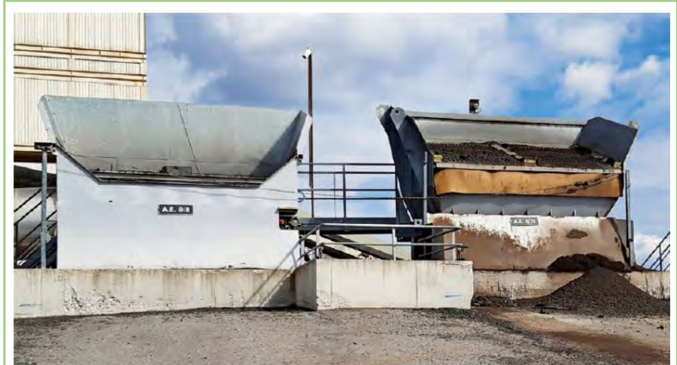
Figure 472 : Dosseurs à agrégats d'enrobés (Source : CEREMA)
