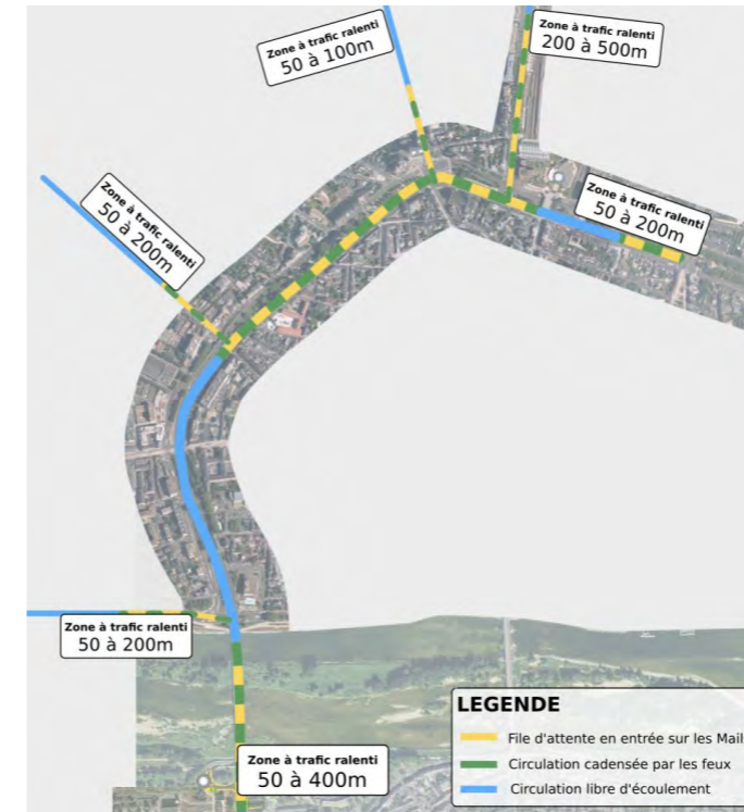
Figure 39 : Synthèse de l'analyse dynamique des zones à trafic ralenti en heure de pointe, en situation de référence (Source : DYNALOGIC)
