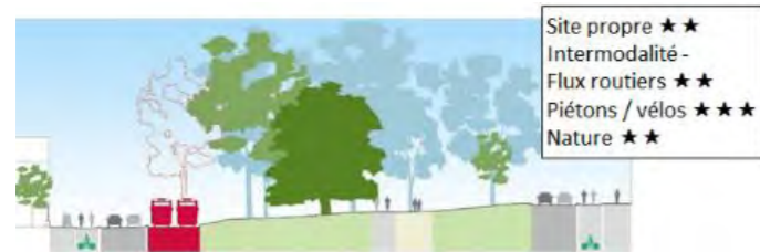
Figure 50 : Schéma du scénario avec un TCSP unilatéral – zoom sur le Bd Jaurès Tracé le plus favorable aux aménagements du mail des sports et au site propre tram. (Source : groupement AMO – étude Plan Guide 2023)
