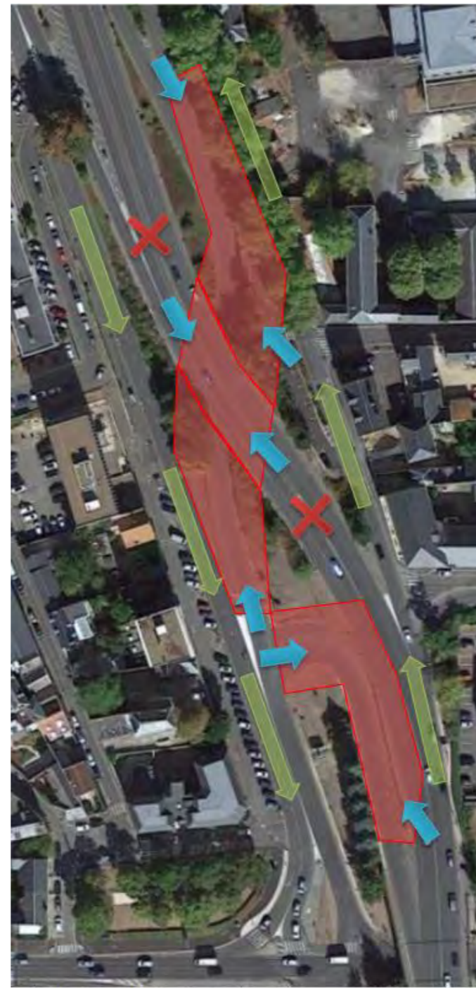
Figure 368 : Implantation du chantier de démolition sur vue aérienne de l'échangeur Joffre
