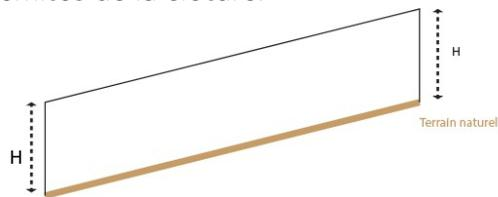
La hauteur de la clôture peut être découpée en sections de minimum 2,5 m, à moduler selon l'importance de la pente et la longueur de la clôture. La hauteur est mesurée au milieu de chaque section.
