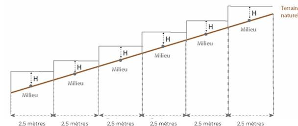
Dans le cas d'une clôture mitoyenne, la hauteur maximale autorisée est mesurée à partir du point le plus bas du terrain naturel.
