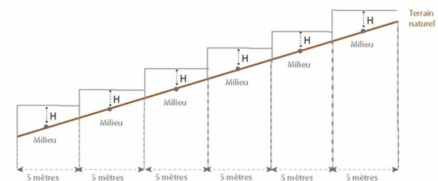
Dans le cas d'une clôture implantée sur la limite séparative, la hauteur maximale autorisée est mesurée à partir du point le plus bas du terrain naturel.
