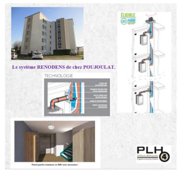
Ce bâtiment collectif de 5 étages avec sous-sol, construit en 1966, a subi une importante rénovation thermique (combles, menuiseries, ITE façades et chaudières), une amélioration des parties communes, l'installation d'un ascenseur et une réfection de ses abords.
